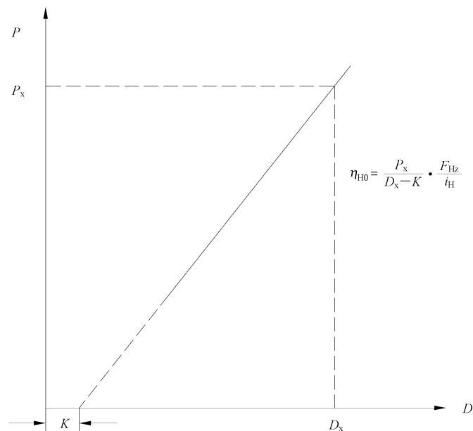
图 L.3 液压传输装置的  $P$ - $D$  关系曲线
