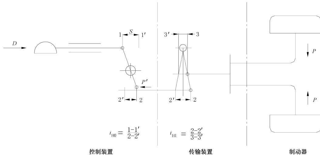
图 L.5 机械传输式制动系统组成示意图
