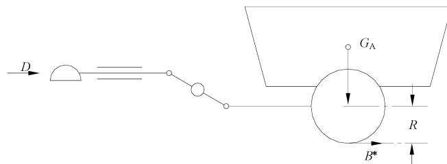
图 L.1 适用于各类制动器的符号
