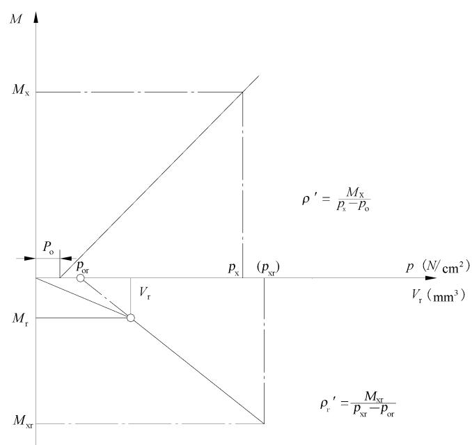
图 L.7 液压制动器  $M-P/M-V_r$  关系曲线
