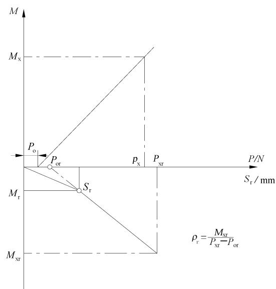
图 L.6 机械制动器  $M-P/M-S_r$  关系曲线
