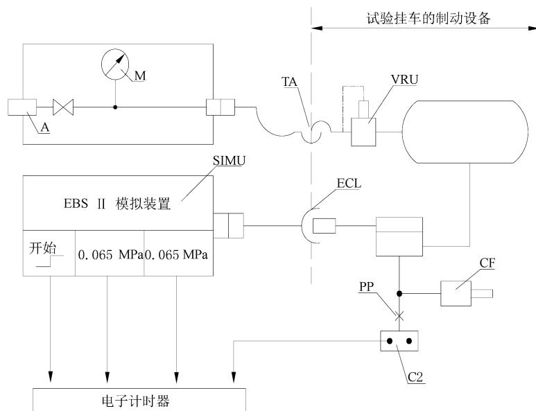
c) 电控线路模拟装置实例
