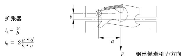
图 L.4 制动器检查示意图
