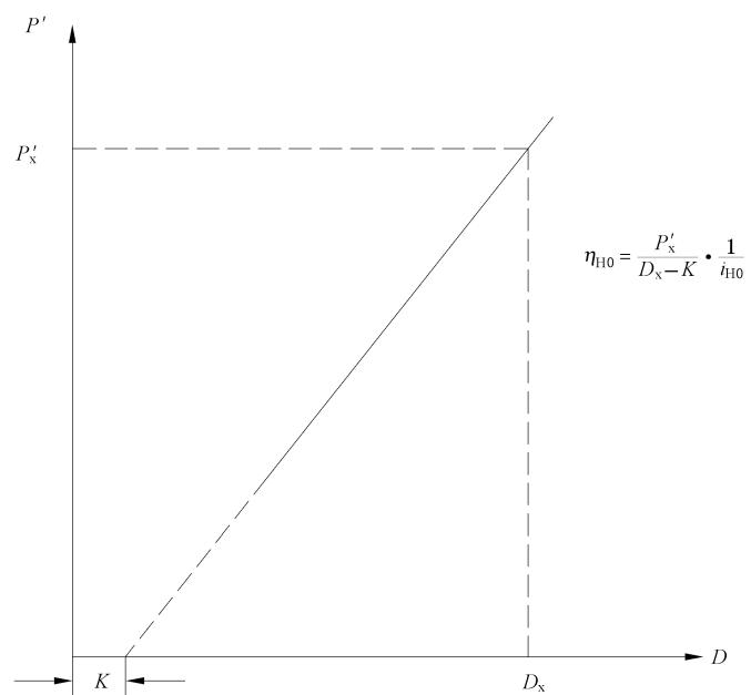
图 L.2 机械传输装置的  $P'$ - $D$  关系曲线
