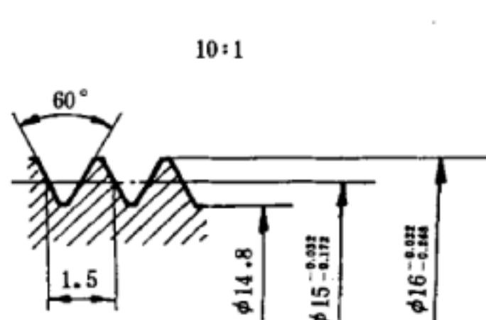
4.6 图样中标注的螺纹长度,均指不包括螺尾在内的有效螺纹长度(图 25);否则,应另加说明或按实际需要标注(图 26)。
